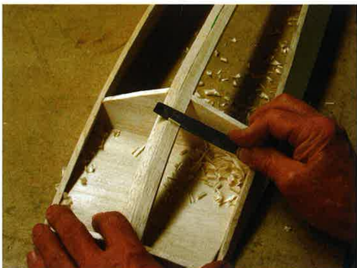
Foto 8: Kiel en zijden aanschuiven.
