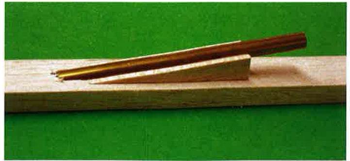
Foto 16: Schroefaskoker door de kiel.
