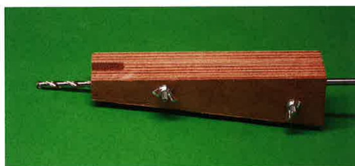
Foto 13: Hulpmiddel boren doorgang schroefkoker.
