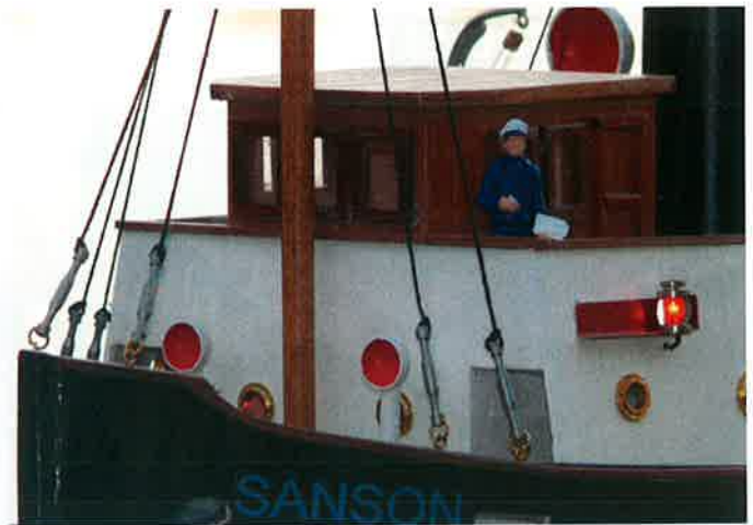
Am Brückenaufbau wurden außen Positionsleuchten angebracht
