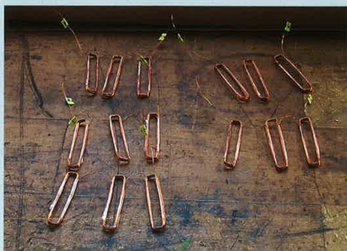
Es waren neun Spulen zu wickeln, von denen immer drei in Reihe lagen
