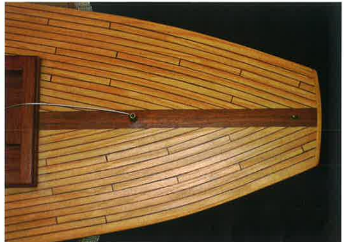
Bild 3: Das fertige Deck mit Fischungsplanken (Kiefer mit schwarzem Furnier)
