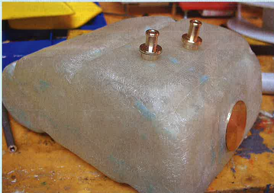
Die Anschlüsse für die Schlauchpumpe
