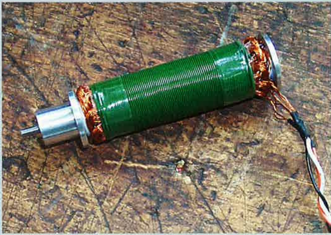
Der Läufer besteht aus einem 8-mm-Sechskantstahl, der mit Neodym-Magneten beklebt wurde
