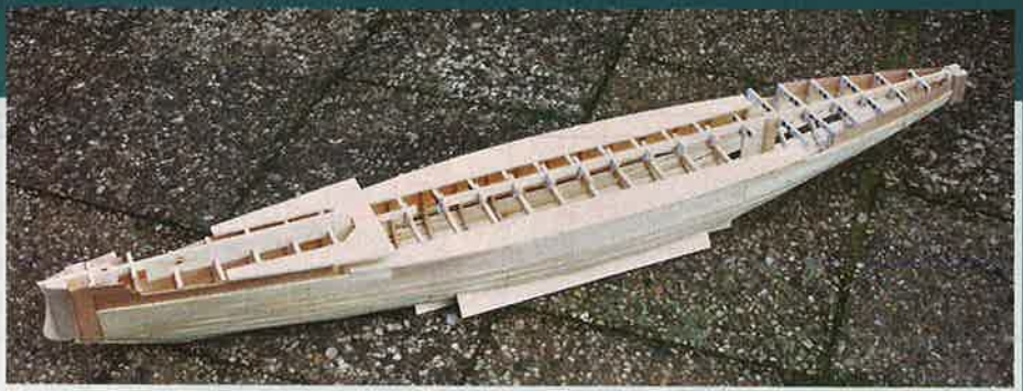
Der Rumpf im Rohbau
