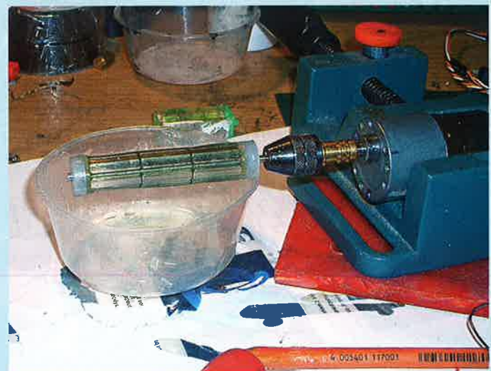
Die Läufer wurden vergossen, der erste mit Hilfe der Drehmaschine, die folgenden mittels eines einfachen Getriebemotors
