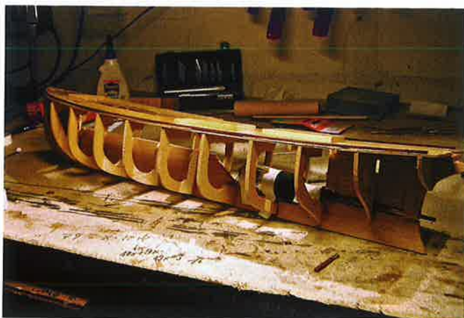
Die Spanten wurden innen ausgesägt, um viel durchgehenden Platz im Rumpf zu schaffen
