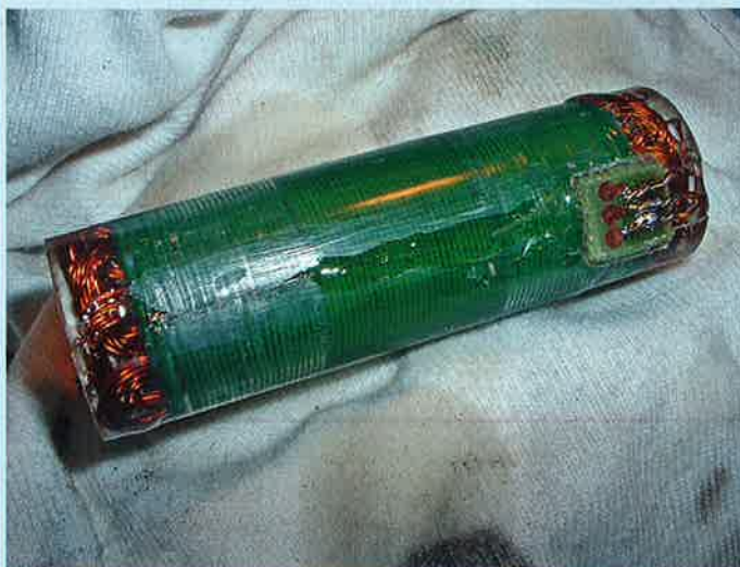
Die Läufer wurden vergossen, der erste mit Hilfe der Drehmaschine, die folgenden mittels eines einfachen Getriebemotors
