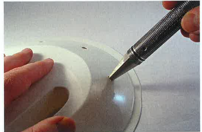
Die Löcher für die Luftführung in der Unterschale bohrt man am besten mit einem Karosseriebohrer aus dem RC-Car-Bereich
