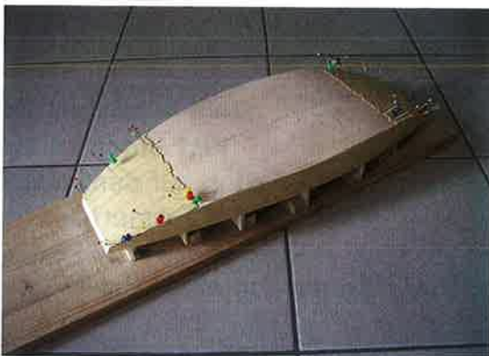
Der Rumpf ist fertig, die Beplankung wird aufgeklebt
