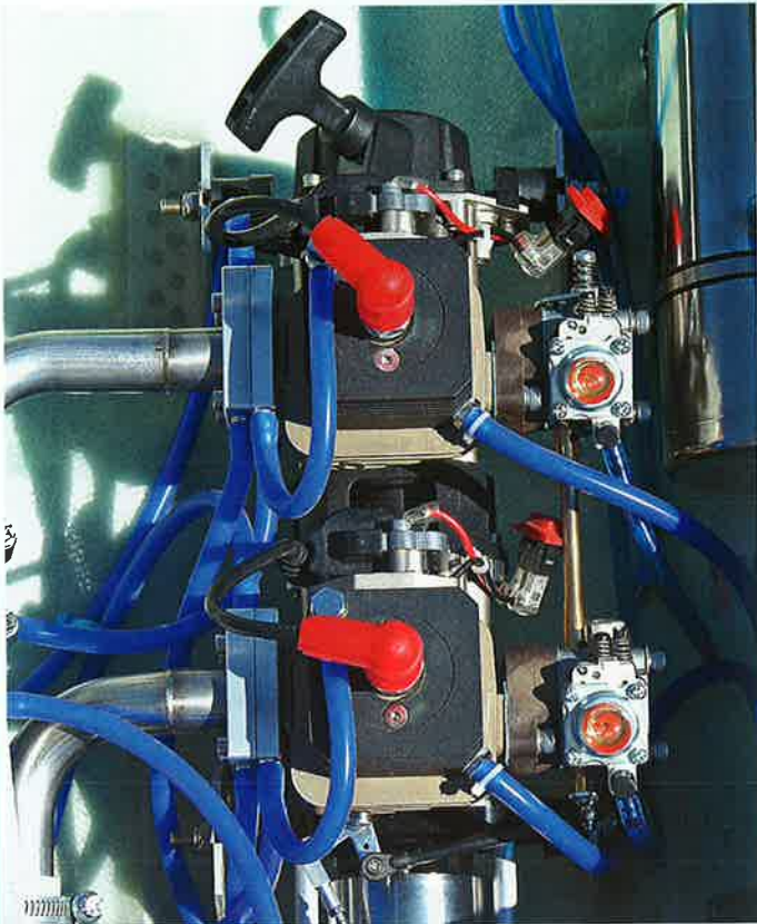
Die beiden Chung-Yang-Motoren von oben gesehen, hier sind auch die wassergekühlten Krümmerflansche und die Menge der Kühlwasserschläuche zu erkennen
