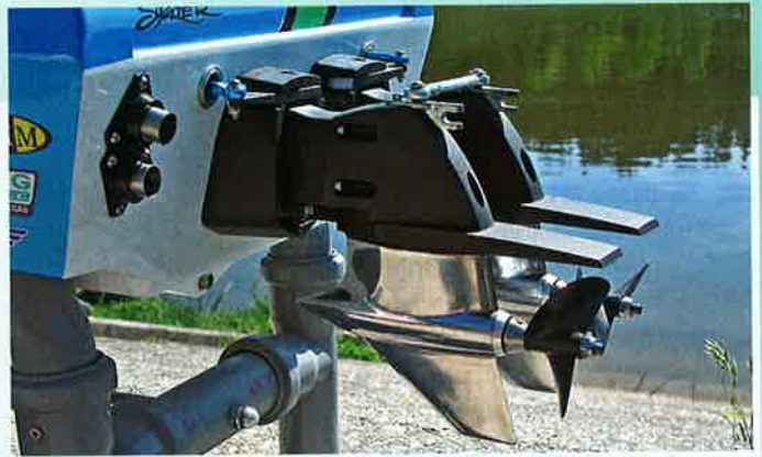
Gekoppelte Z-Antriebe, Anlenkung und Resonanzrohr-Auslass, die Antriebe noch mit den mitgelieferten 70 mm Carbon-Propellern
