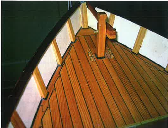
Bild 4: Das fertig beplankte Deck einer Segeljacht (Esche mit Teakholz)
