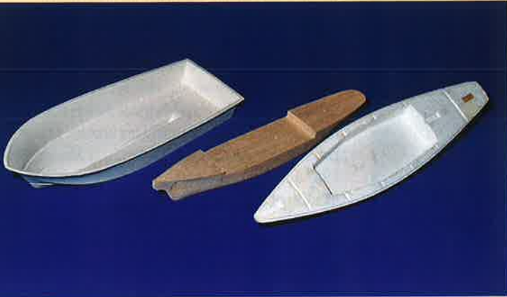
Rumpfmateriel Terluran 1968, Balsa 1965, Schaumplastik 1962
