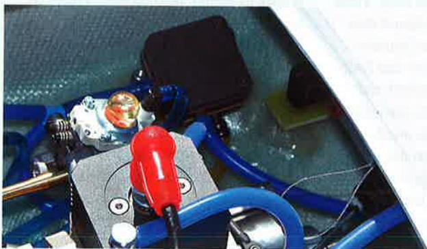
Die Wasserpumpe zur Kühlung der beiden Zylinderköpfe
