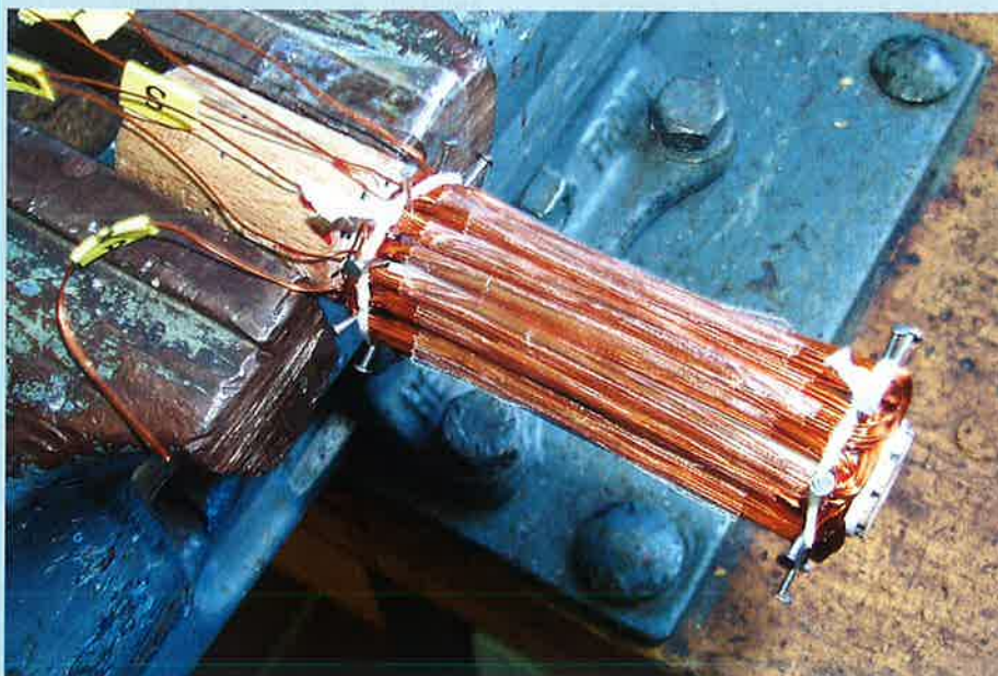
Die Wicklungen wurden zuletzt mit Tesafilm umklebt
