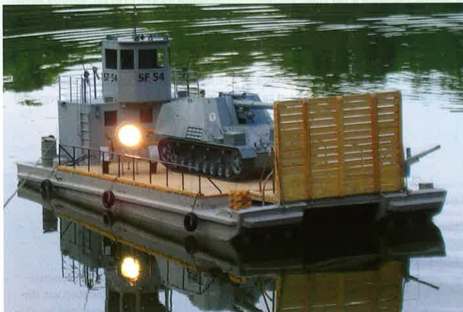
Mit dem zusätzlichen (verdeckten) Auftriebskörper kann die Fähre viel Ladegut aufnehmen
