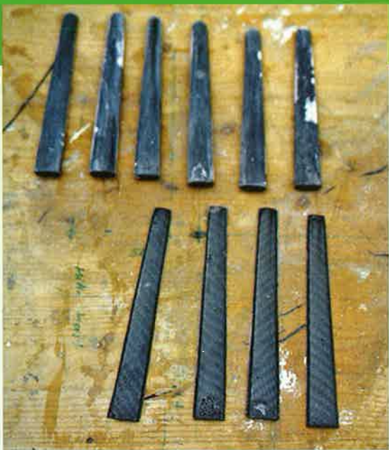
Salings im Rohbau
