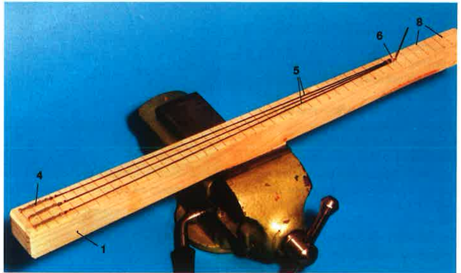
Die Vorbereitung: 1 = Holzleiste, 4 = Spanschluss, 5 = Wanten, 6 = Haken, 8 = Einteilung
