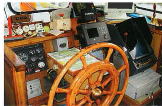
Der Steuerstand zeigt neben modernen nautischen Anzeigen auch das alte große Steuerrad
