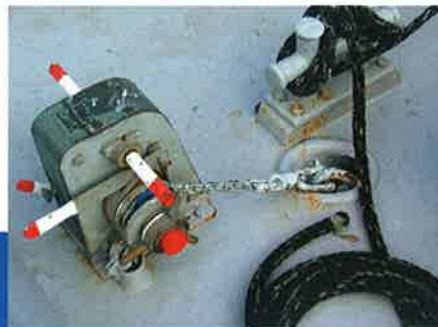
Das Ankerspill hat bescheidene Ausmaße. Mehr braucht so ein kleiner Tümmler nicht
