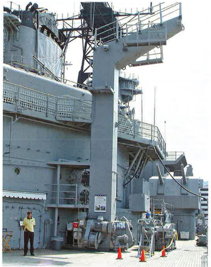
Der nur an Steuerbord vorhandene Galgen für die Einrichtungen der Querab-Versorgung in See. An seinem Fuß die zugehörigen Ladewinden (Foto: Jürgen Eichardt)
