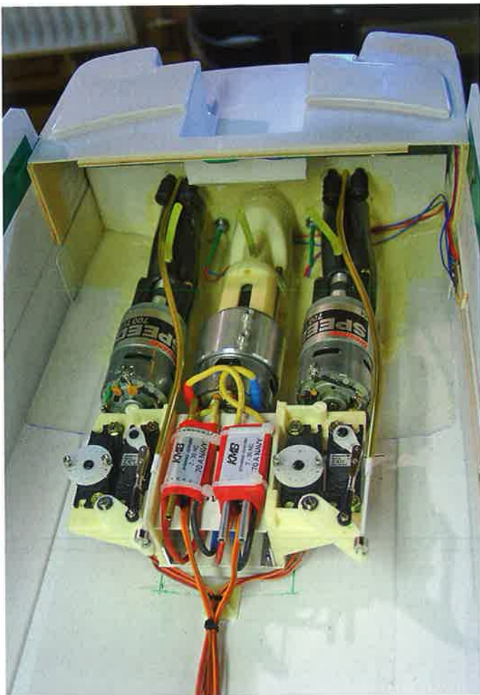
Der Antrieb: zwei Kamewa-Jets und ein Booster
