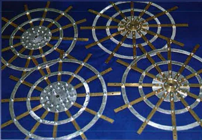
Vormontierte Radkränze für die Schaufelräder
