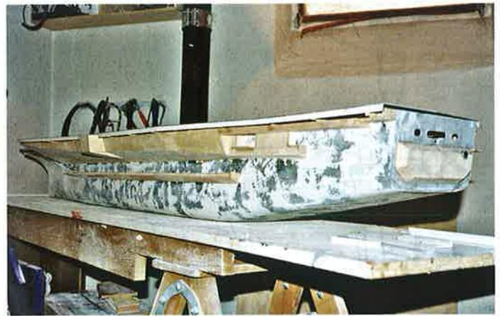
Die seitliche, lange Plattform (Galerie) und der Sperrholzanbau am Heckspiegel
