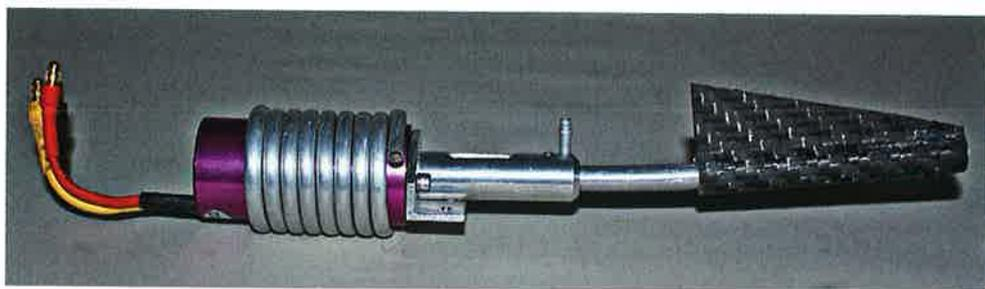
Die Welle ist auf den wassergekühlten Motor montiert
