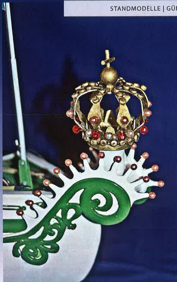
◀ Die Bugkrone wurde als Abwicklung gezeichnet, aus Messing ausgesägt, in beiden Richtungen gebogen und gelötet
