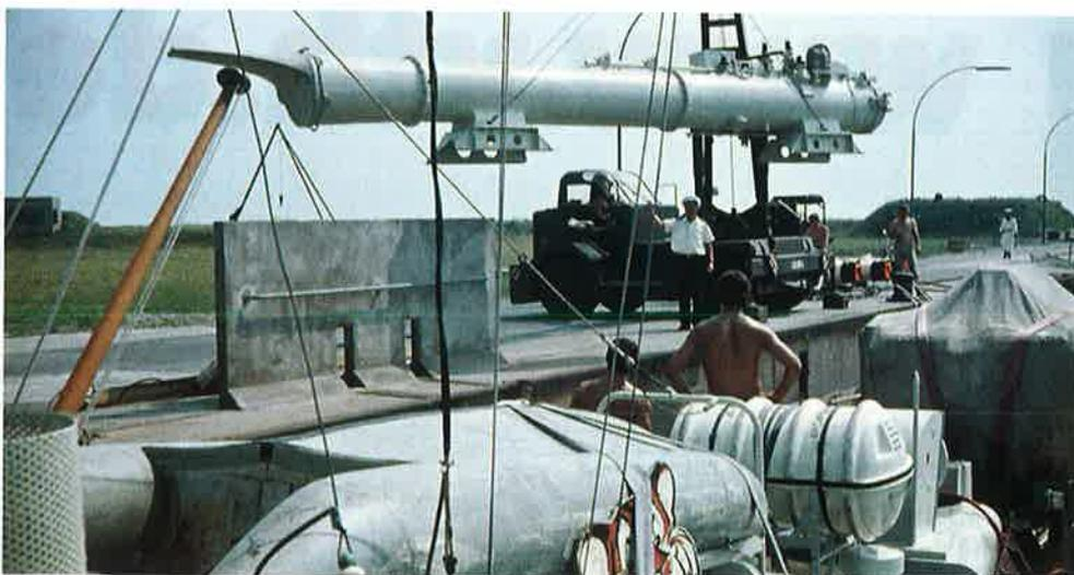
Foto 2: Beim TS-Boot *Tiger* wird das achterliche Torpedorohr zur Vorbereitung auf eine Minenaufgabe entfernt (Foto: Sammlung Eichardt)
