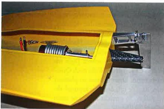
Der CFK-Ausleger ist im 45°Winkel montiert und gibt der Welle Halt
