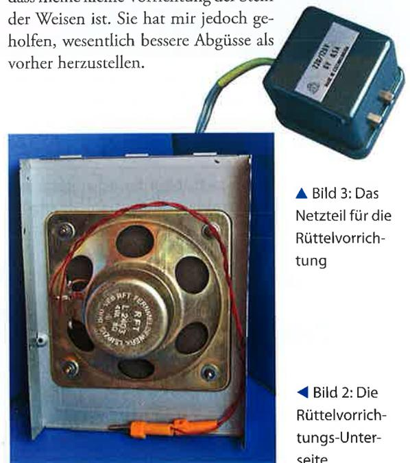
▲ Bild 3: Das Netzteil für die Rüttelvorrichtung
