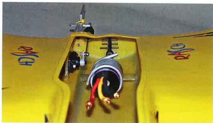
Der Blick auf den Heckspant zeigt die Durchführungen und die Befestigung des Wellenkanals
