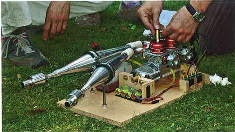
Die ersten Testläufe eines 2-Zylinders auf Basis der MTC-Kurbelwellengehäuse. Der Motor ist mit einer elektronischen Zündanlage ausgestattet
