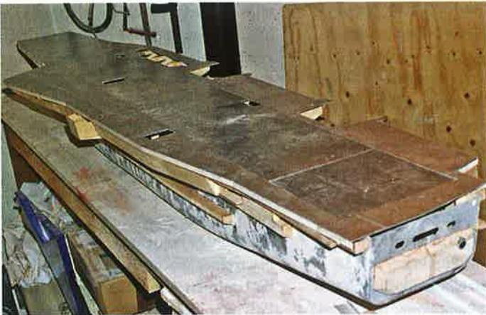
Das fertig zugeschnittene Alu-Blech mit dem ABS-Streifen entlang des Catwalks
