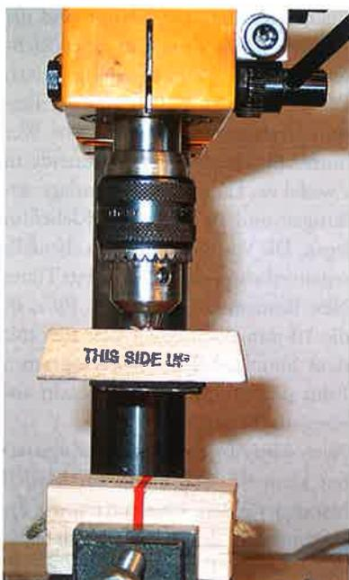
Bild 7: Stempel, in der Fräsmaschine ausgerichtet (für die Sprengstoffkisten auf Bild 1)
