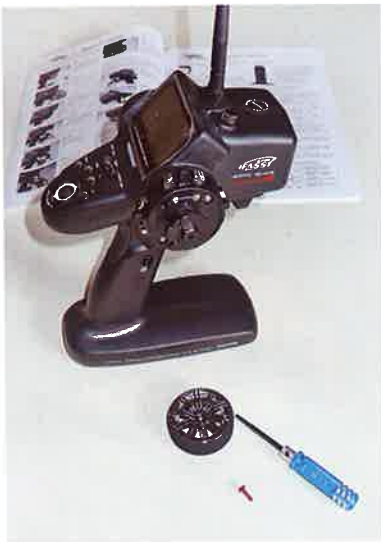
Das Lenkrad lässt sich mit wenigen Handgriffen auf der anderen Senderseite montieren ...
