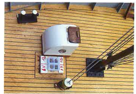
Auch die Ladeanschlüsse sind unter einem Niedergang verborgen
