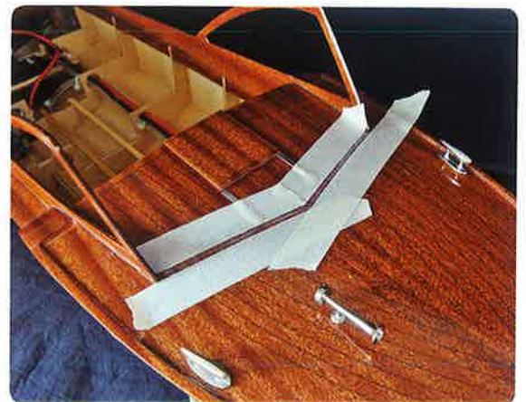
Schutz des Decks beim Schleifen
