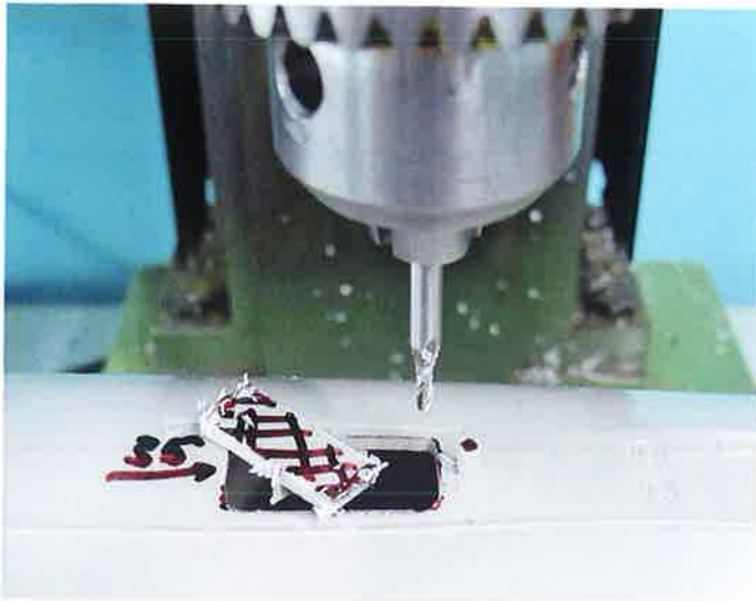
Ausfräsung für die Anlenkung der Turmruder
