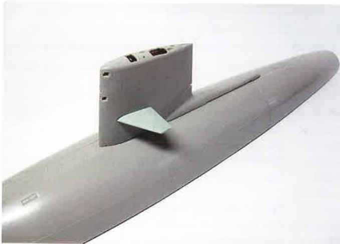
Ausfräsung für die Anlenkung der Turmruder
