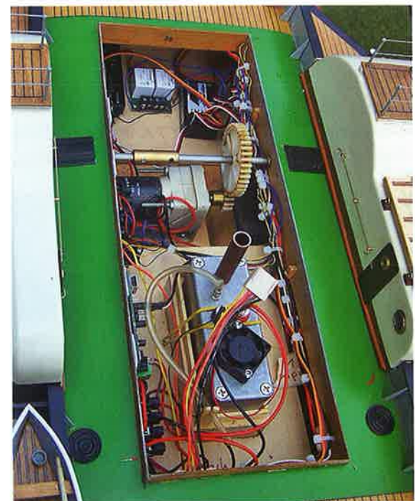
Blick ins Innere auf Antrieb und Dampfgenerator
