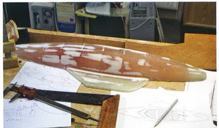
▲ Spachtel- und Schleifarbeiten ◀ Der Rohling aus Kunstharz
