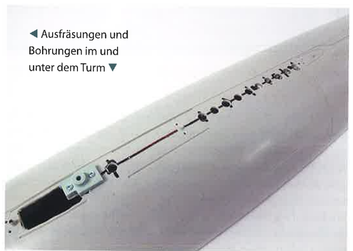
Montage des Schnorchels direkt hinter der Ausfräsung
