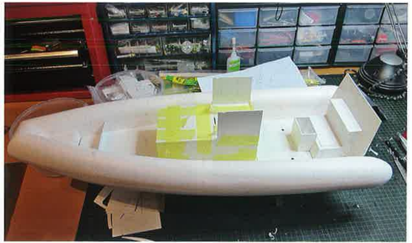
Aus passgenauen Frästeilen entsteht der Aufbau
