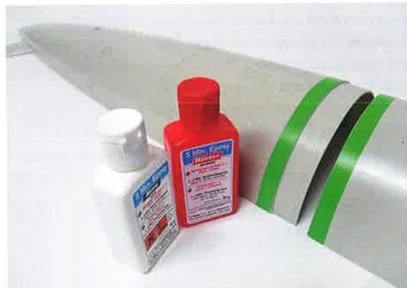
◀ Zusammenkleben der Rumpfvorder- und -hinterteile
