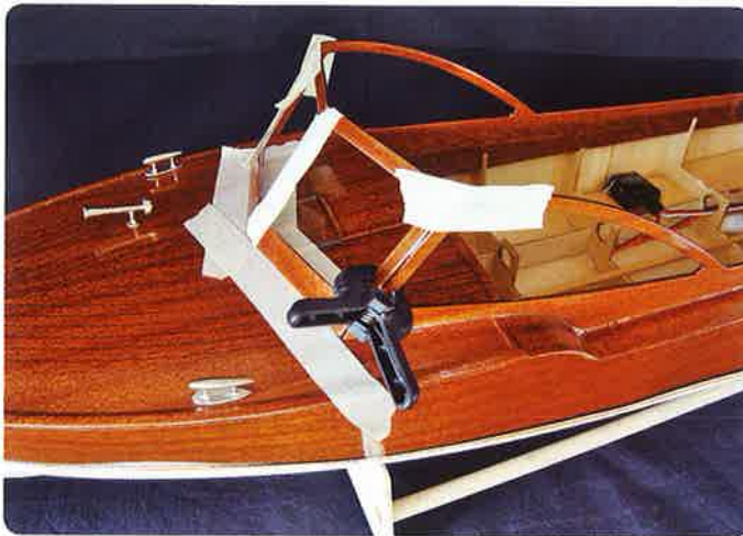
Einbau der Scheibenrahmen
