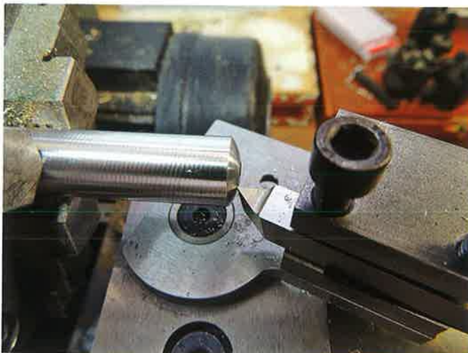
Fertigen des Spillkopfes
