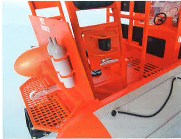
Druckflaschen an der Rückwand für den „Airbag“
