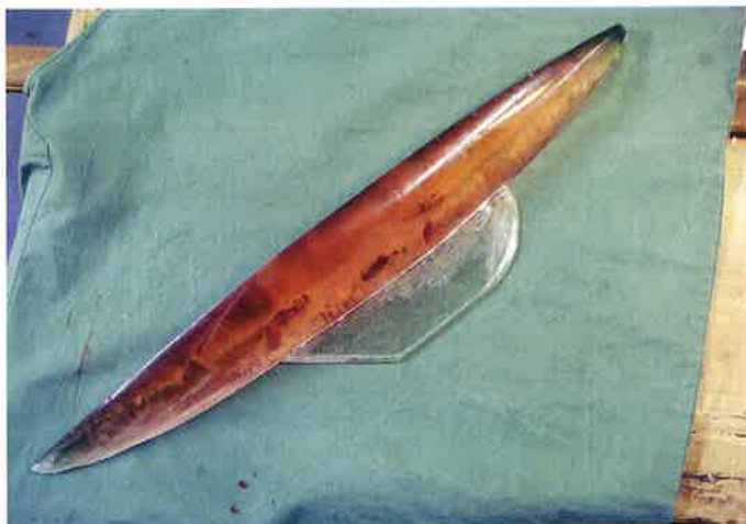
▲ Spachtel- und Schleifarbeiten ◀ Der Rohling aus Kunstharz
