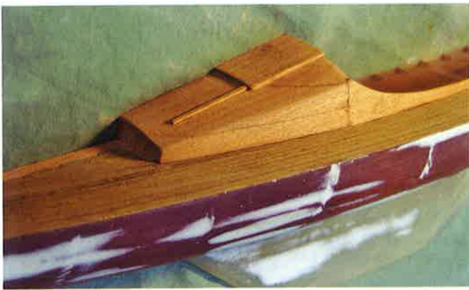
Kajüte und Cockpit-Süß sind montiert
