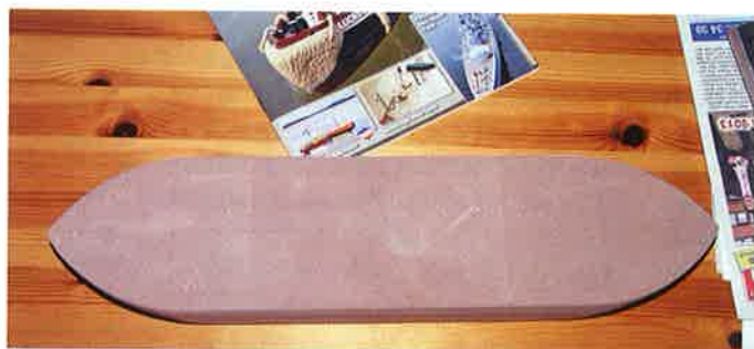
Der angefertigte Tiefziehkern
