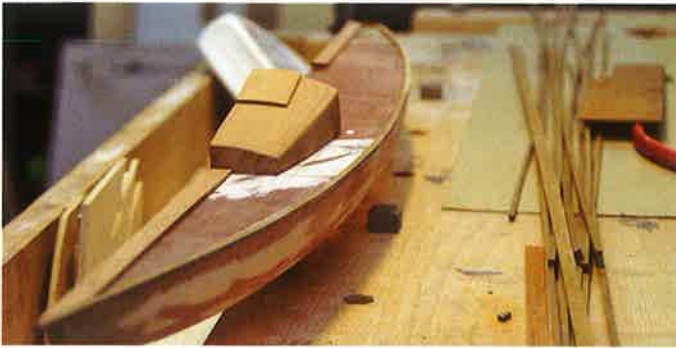
Die Kajüte auf Deck – die erste Planke ist verklebt
