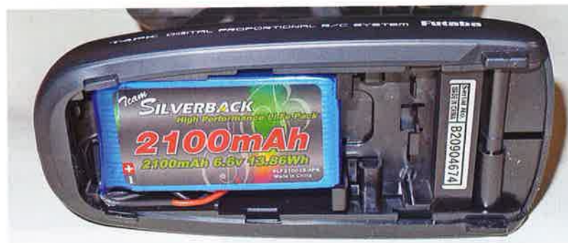
◀ Der neue LiFe-Akku hat eine höhere Kapazität bei gleichzeitigem geringeren Gewicht
