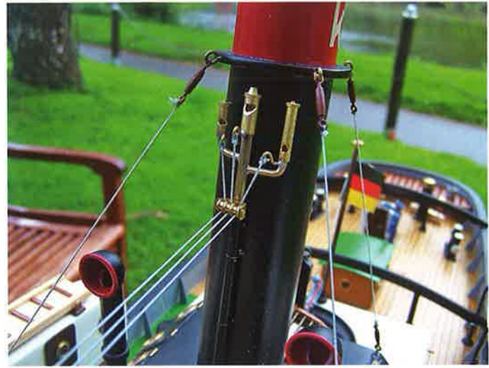
Die Ansteuerleinen für die Dampfpeifen
