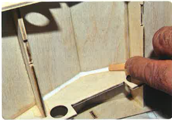
Glattziehen des Klebstoffes beim Verkleben der Bodenplatten
