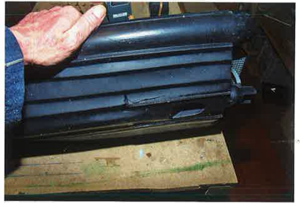
Leitstringer am Jet-Einlass des RIBs
