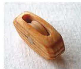
Selbst hergestellter Rollenblock ohne Halteösen und noch nicht gebeizt
