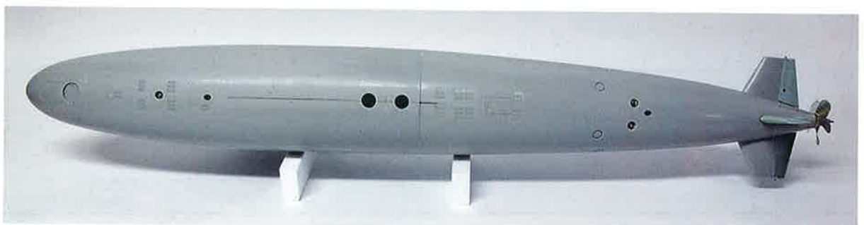
► Verschraubungen der Rumpfschalen und „Flutlöcher“ unten
