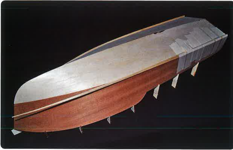
Aufkleben der Dreikantleiste zur Verbesserung der Seitenführung
