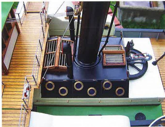
Das Kesselhaus erhielt neue Bullaugen aus Messing
