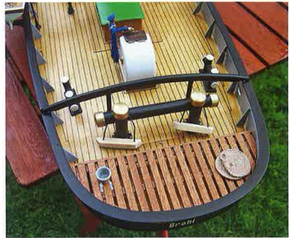
Die Grätung aus Mahagoni kann jederzeit entfernt werden, um Einstellungen am Ruder vorzunehmen
