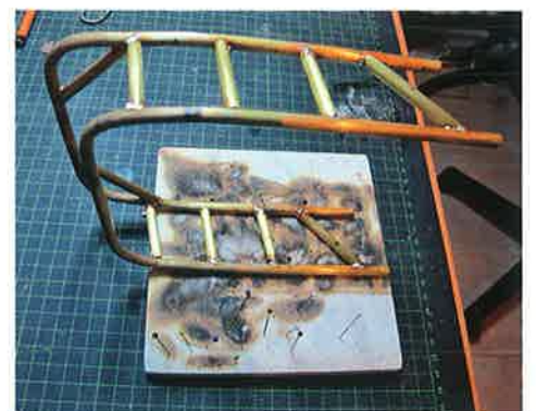
▲ Lötarbeiten am hinteren Geräteträger
